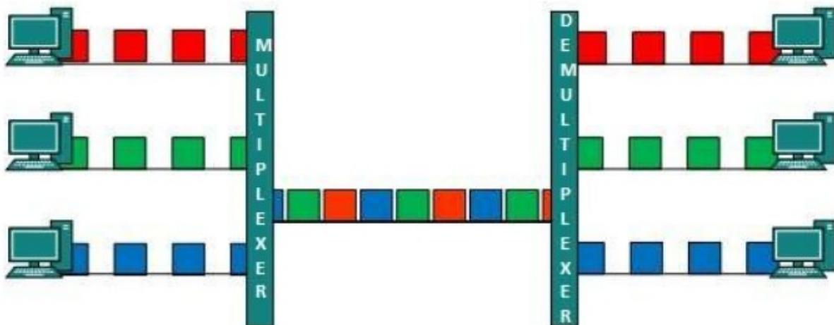
Consiste en la capacidad de enviar PDU de diferentes protocolos de la capa de red a través del mismo enlace. Para ello se **etiquetan** las tramas de algún modo **indicando el protocolo** que se está encapsulando. De esta forma el receptor puede reconocer qué transporta esa trama sin necesidad de analizar los datos encapsulados. Esto le puede permitir dar un trato distinto a cada trama en función del protocolo que transporta.
