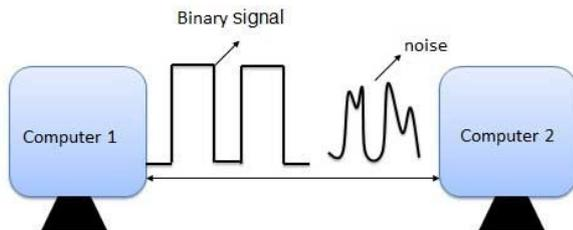
Los protocolos del nivel de enlace suelen ofrecer algún mecanismo para la **detección** de los errores que puedan producirse durante el transporte de la trama a través del enlace. En ese caso el receptor puede detectar que una trama contiene errores y puede, dependiendo de las características del protocolo, realizar dos acciones:
