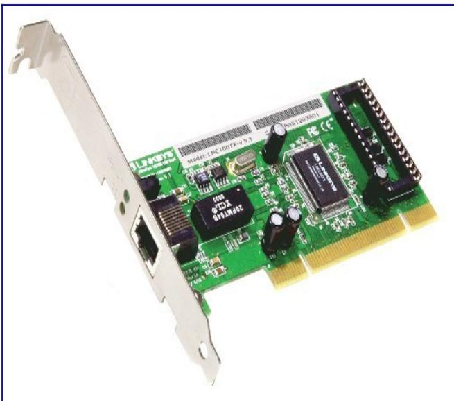
Es la encargada de realizar las funciones de conexión entre el dispositivo que queremos conectar a la red (impresora, ordenador, telefono, etc) y la propia red de comunicaciones
