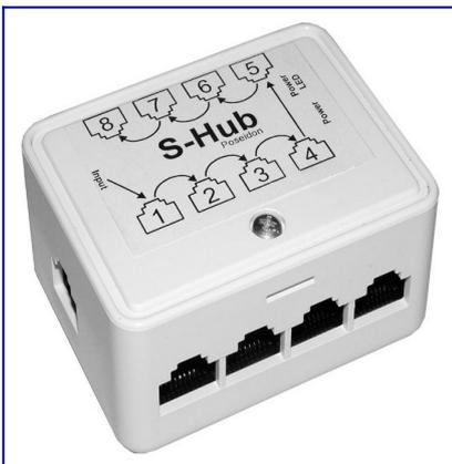
Es un dispositivo que permite centralizar el cableado de una red y poder ampliarla. Esto significa que dicho dispositivo cuando recibe una señal por uno de sus puertos repite esta señal emitiéndola por el resto de puertos del mismo.
