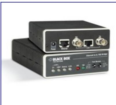
Un puente de red o bridge es un dispositivo que divide la red en dos segmentos, de tal forma que los paquetes que se envían a una red no colisionan con los que se envían a la otra.
